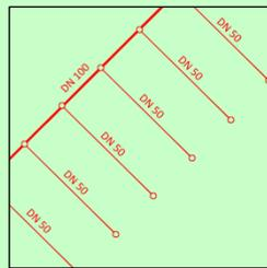
Bei der **Vektorisierung** werden die einzelnen Drainagebestandteile (Sammler, Sauger, Revisionschächte u.a.), die bis hierhin nur als Rasterdaten („Pixel“) vorliegen, in Vektorelemente überführt, die dann attribuiert (Material, Durchmesser, Verfilterung u.a.) und symbologisiert werden können (→ Shape-Datei).
